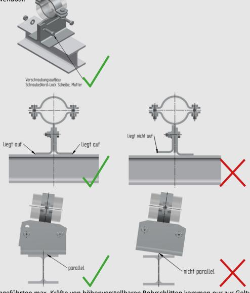
Die im Katalog angeführten max. Kräfte von höhenverstellbaren Rohrschlitten kommen nur zur Geltung, wenn die Rohrschlitten, wie oben beschrieben, montiert werden.
