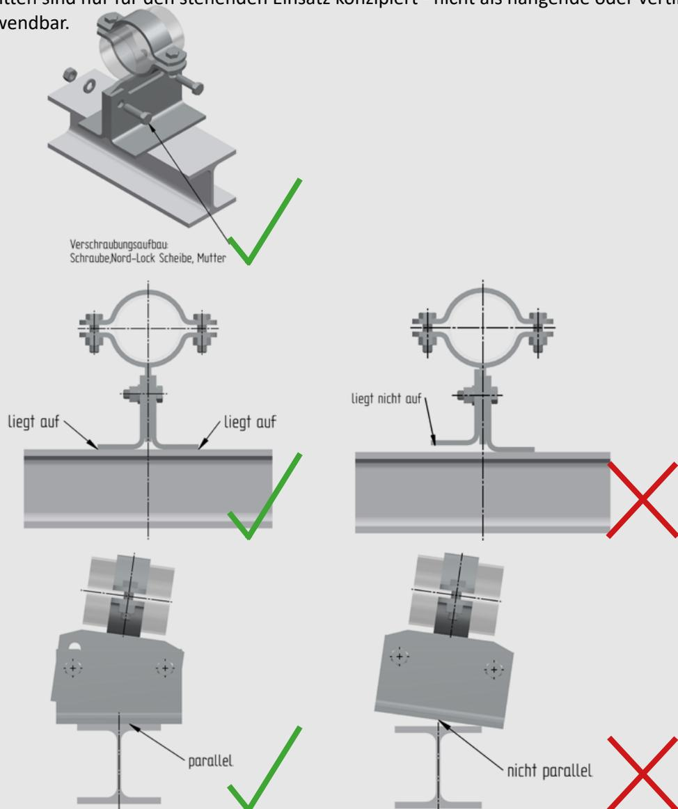
Die im Katalog angeführten max. Kräfte von höhenverstellbaren Rohrschlitten kommen nur zur Geltung, wenn die Rohrschlitten, wie oben beschrieben, montiert werden.
