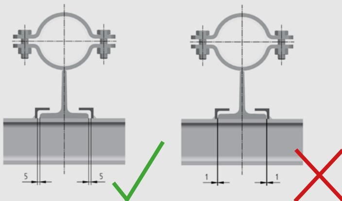
Der Führungswinkel muss beim Einbau des Führungslagers mittig sitzen, um eine Bewegung in beide Richtungen zu ermöglichen. Ebenfalls ist der Weg der axialen Bewegung des Rohres mit der Führung abzustimmen, um ein Herausfahren aus der Führung oder eine Kollision mit dem Rohrschlitten zu vermeiden.
